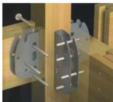
テックワンは在来軸組工法の弱点を補うために開発された「クレテック」を更に進化させた接合金物です。木材の欠損部を極力減らし、「継手」や「仕口」部分を金具で接合・緊結することで高い精度と安全性を実現。さらに、震度7の地震にも動かない頑強な軸組を作るため、強度実験を定期的実施・検証しています。
