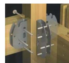
テックワンは在来軸組工法の弱点を補うために開発された「クレテック」を更に進化させた接合金物です。木材の欠損部を極力減らし、「継手」や「仕口」部分を金具で接合・繋結することで高い精度と安全性を実現。さらに、震度7の地震にも動じない頑強な軸組を作るために、強度実験を定期的に実施・検証しています。
