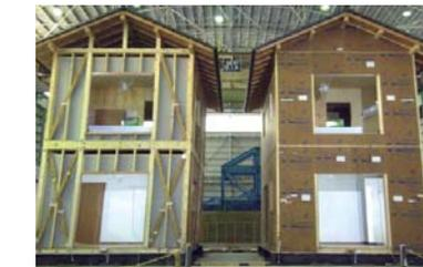
ダイライトMSは未利用の無機質原料を有効利用し、DAIKEN独自の技術で開発された耐力面材です。ダイライトの壁は力を全体で受け止め、分散させるために万一の場合にも優れた強度を発揮します。
