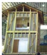
安心・安全の住まいづくりを実現する「ダイライト工法」。地震や台風**に強い高強度壁倍率2.5倍を実現。**
