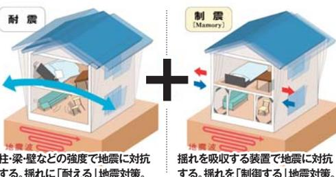
柱・梁などの強度で地震に対抗する。揺れに「耐える」地震対策。
